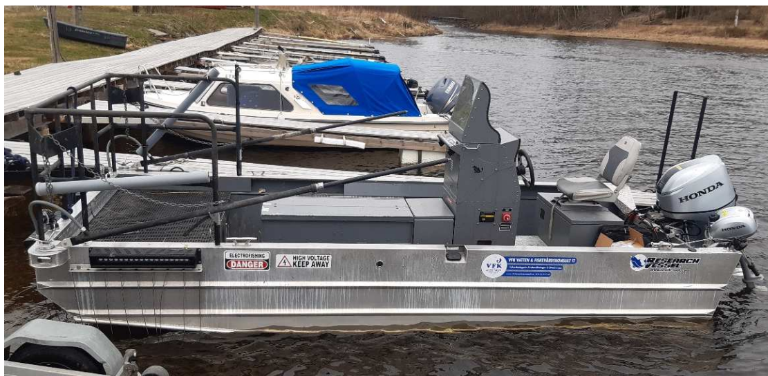
Figur 2. Foto som illustrerar Smith-Rooth elfiskebåt av H-modell.
